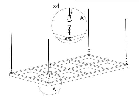
Introducir las patas hasta que la varilla sobresalga por el centro de la pletina. Colocar las arandelas y tornillos en los extremos de las patas con la llave de tubo.
