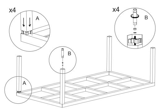
4 Colocar las tapas de las patas y enroscar los tacos de las patas.
